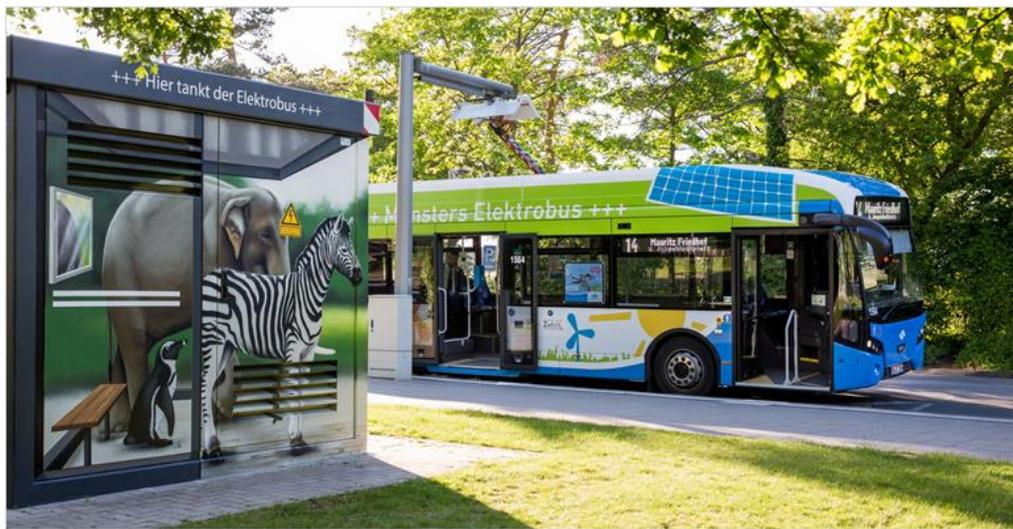
Abb. 101: E-Bus Schnelladestation in Münster (Bild: Stadtwerke Münster)
