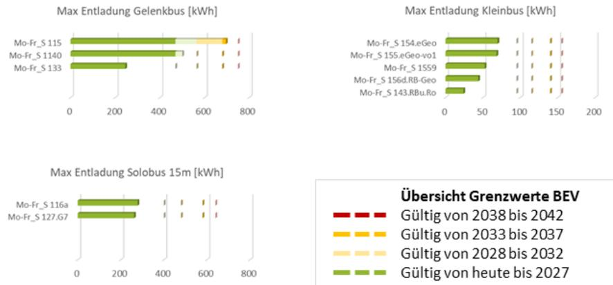
Abb. 9: Maximale Batterieentladung Einzelumläufe Datensatz Röhler – weitere Fahrzeugtypen (BEV)
