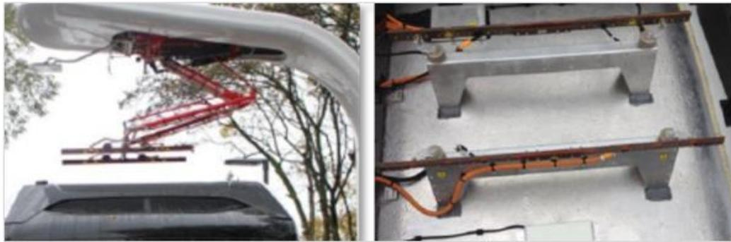
*Abb. 96: Siemens / Volvo Pantograph und Kontaktschienen (Bild: Siemens AG)*
